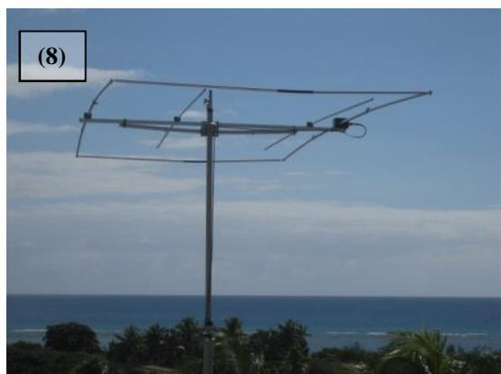
Je construis une nouvelle version multi-bande pour le 12-15-17 et 20m **(9)**. Très bons résultats sur 15-et 17m avec de gros pile-up de JA ainsi que bien des VK-ZL par le long-path mais le 20m ne fonctionne pas vraiment bien. La base de l'antenne est trop proche du toit plat et des barrières métalliques.
