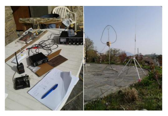
L'antenne HF-P1 utilisée est une verticale raccourcie avec une bobine de réglage et 4 radians de 5 mètres.
