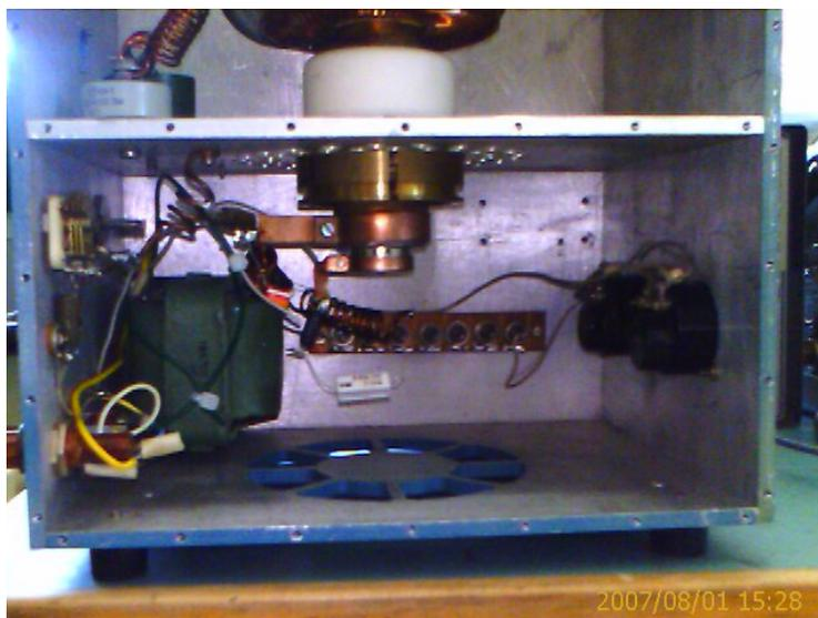
La photo du bas montre le compartiment grille avec le transfo pour le chauffage du filament, le circuit d'attaque et 2 luxueux galvanomètres (HI). Enfin l'aspect initial plutôt rustique, laisse penser à un budget de matériel soviétique...
