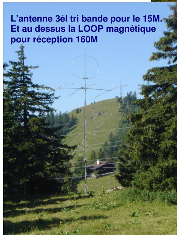
**L'antenne 3él tri bande pour le 15M.
