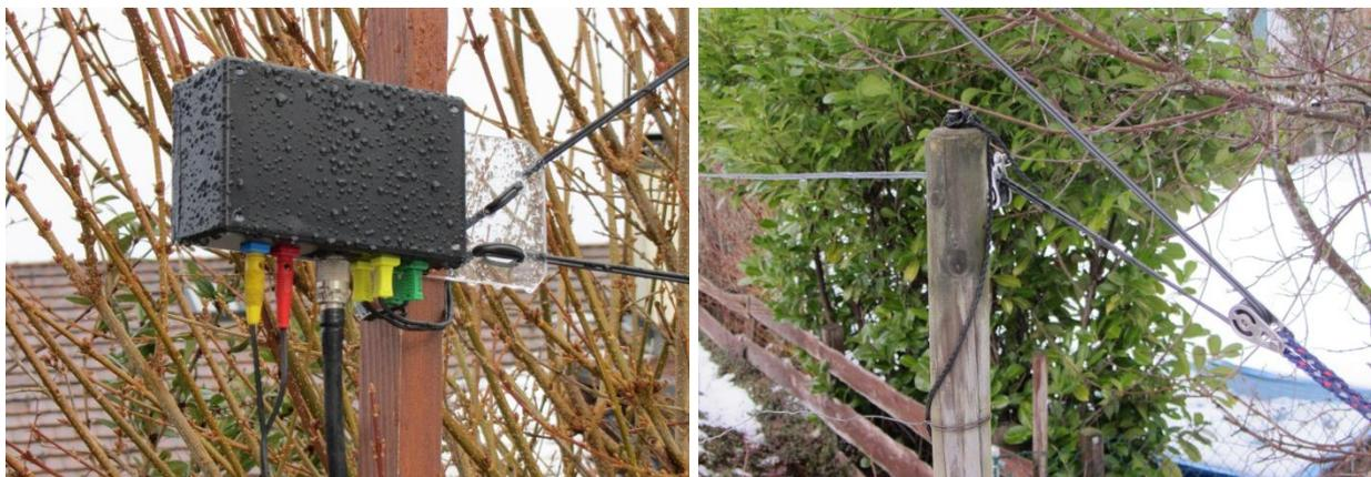
**Fig. 10 : Point d'alimentation (source avec boîte d'accord) et terminaison**
