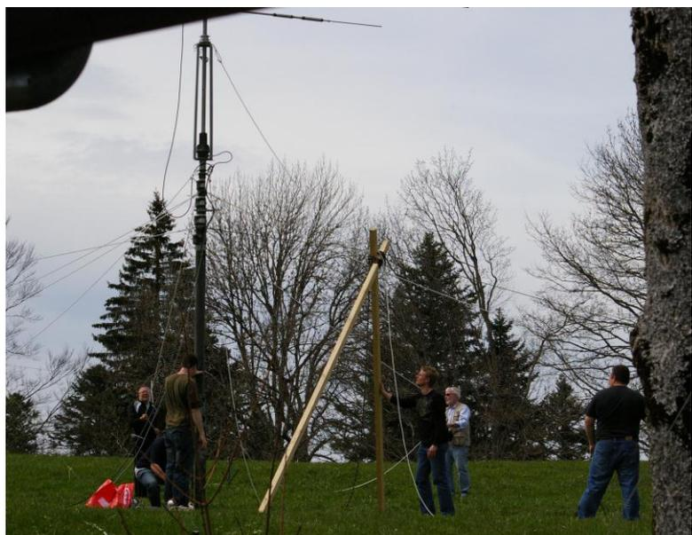
On fait quelques essais avec la verticale : elle a un bon SWR entre 1,8 et 1,95MHz (par commutation à distance de l'inductance en série avec les radians élevés).
