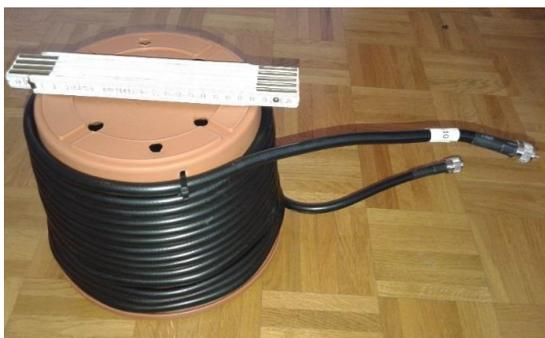
**Fig. 4 : Choke ; 10m de coaxial bobiné sur un "pot de fleur" d'environ 20cm de diamètre**
