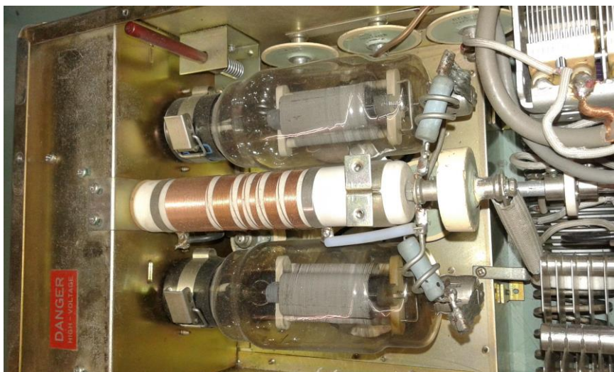
Vue du PA dans son état original avant la modification
