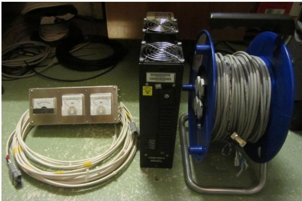
**Fig. 9 : boîte de contrôle, câble pour le 50V (blanc), alimentation 50V et câble de liaison (gris) entre le PA-LNA et la boîte de contrôle.**
