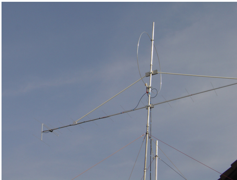
Fig. 7 : La LOOP en place au dessus de l'antenne 144MHz
