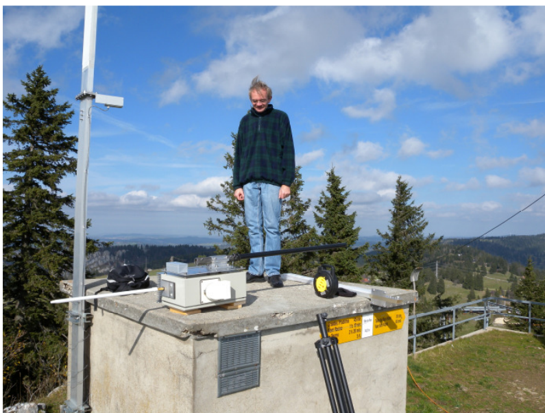
Essais des nouvelles balises 2,3GHz et 10GHz. Le mât à gauche est l'antenne à fentes de la balise 1,3GHz.
