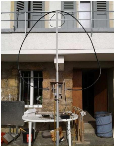
Antenne LOOP magnétique
