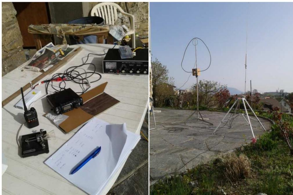
L'antenne HF-P1 utilisée est une verticale raccourcie avec une bobine de réglage et 4 radians de 5 mètres.
