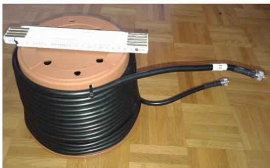
**Fig. 4 : Choque ; 10m de coaxial bobiné sur un "pot de fleur" d'environ 20cm de diamètre**
