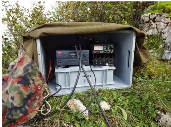
Les accès coaxiaux étant situés à l'arrière de l'amplificateur et la caisse étant relativement petite, nous avons ajouté des adaptateurs N-N coudés mâle-femelle (voir photo ci-dessous) pour éviter de plier trop fortement les coax.
