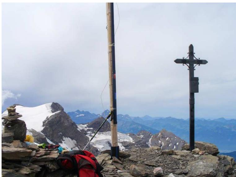
Après pas mal d'essais avec différentes antennes, long-fil, dipôle, verticale, V-inversé, etc. j'ai trouvé mon antenne préférée: une simple verticale de 7,50m de fil, attachée au mât télescopique, avec comme contrepois entre 3 et 5 radiants posés au sol.
