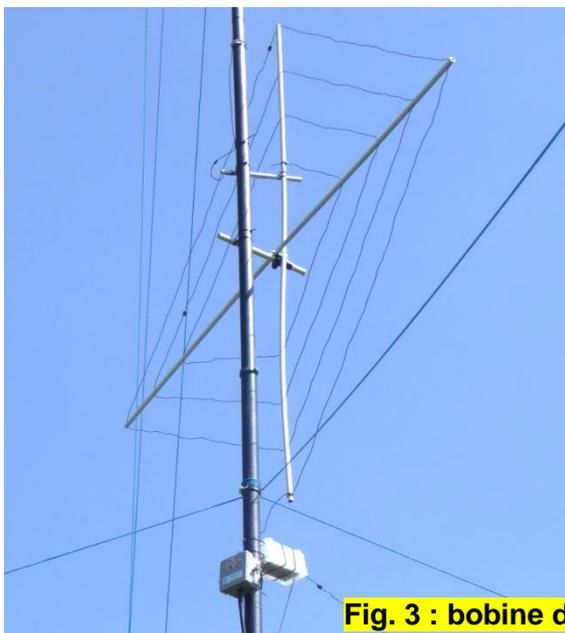
En positionnant cette bobine relativement proche de la pointe (du bas) de l'antenne, on en maximise sa résistance de rayonnement, et l'on minimise ainsi les pertes tout en obtenant une bande passante acceptable.
