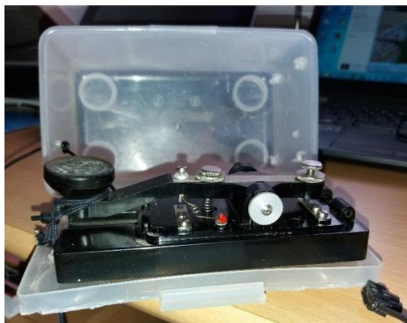
**Fig. 4 : le relais CW/SSB (avec sa commande par cordelette...)**
