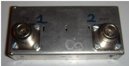
Afin de trouver une solution à ce problème d'interférence, j'ai cherché à construire un filtre supprimant l'harmonique trois du 70cm en sortie de l'émetteur. En effet  $3 \times 432 \text{ MHz} = 1296 \text{ MHz}$ , qui sont les deux fréquences de trafic qui sont utilisées lors des contests UHF.
