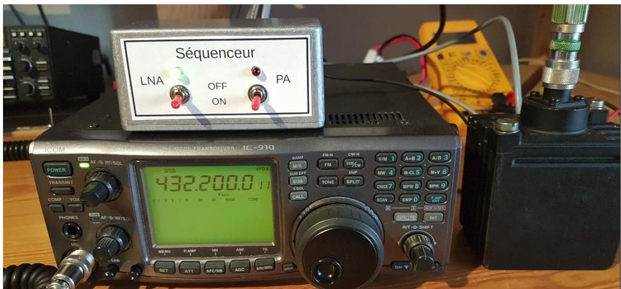
L'émetteur (ici un ICOM IC-910) fournit sur la prise ACC en face arrière tous les signaux nécessaires au fonctionnement du boîtier : 12V (jusqu'à 1 A), PTT et Masse.
