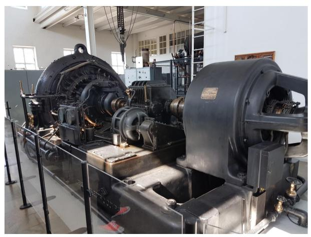
La modulation de type CW est appliquée sur le signal radio par un modulateur magnétique dont la réactance de la bobine varie en fonction d'un signal DC saturant plus ou moins le noyau. Ce modulateur est représenté sur la photo ci-dessous.
