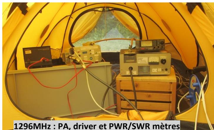
1296MHz : PA, driver et PWR/SWR mètres
