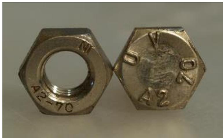
Dans la norme ISO la classe des vis et écrous en inox est symbolisée par une lettre et un chiffre indiquant le type d'inox. (A2, A4,...) suivi d'un nombre qui indique la résistance à la traction divisée par 10 (par exemple 70 indique 700 Newton/mm<sup>2</sup> de résistance à la traction).
