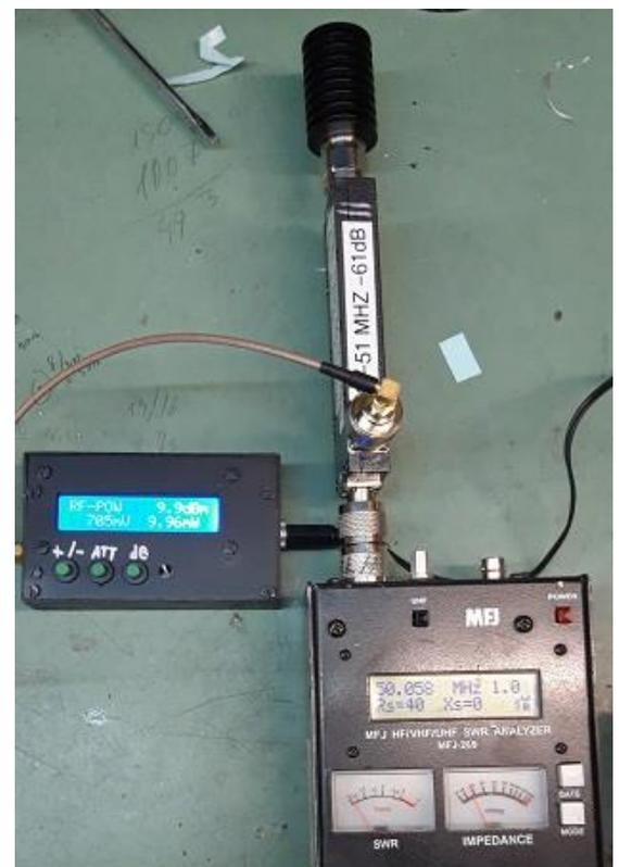
Le wattmètre reçoit 10 mW – 61 dB soit environ 8nW.
