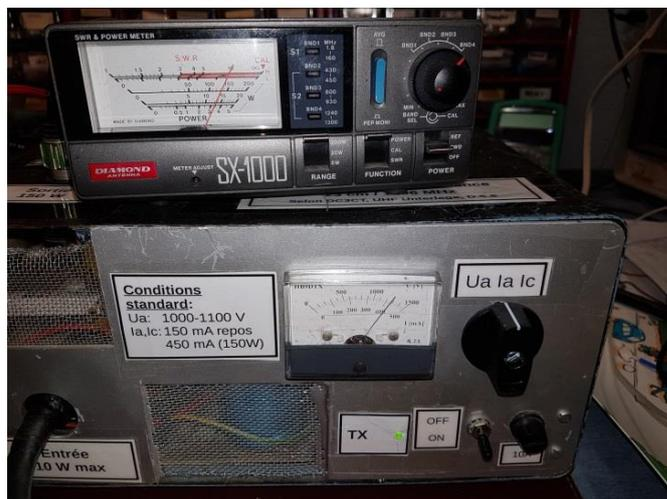
En effet la station de base donne au maximum 10W et à cause de la perte dans le câble entre la station et la tente (25m de câble → -4.2dB...), la puissance d'excitation du PA était insuffisante. La boîte avec le driver a aussi un PWR/SWR mètre, avec lecture possible depuis la tente et aussi depuis la station. Tout cela sera bien utile.
