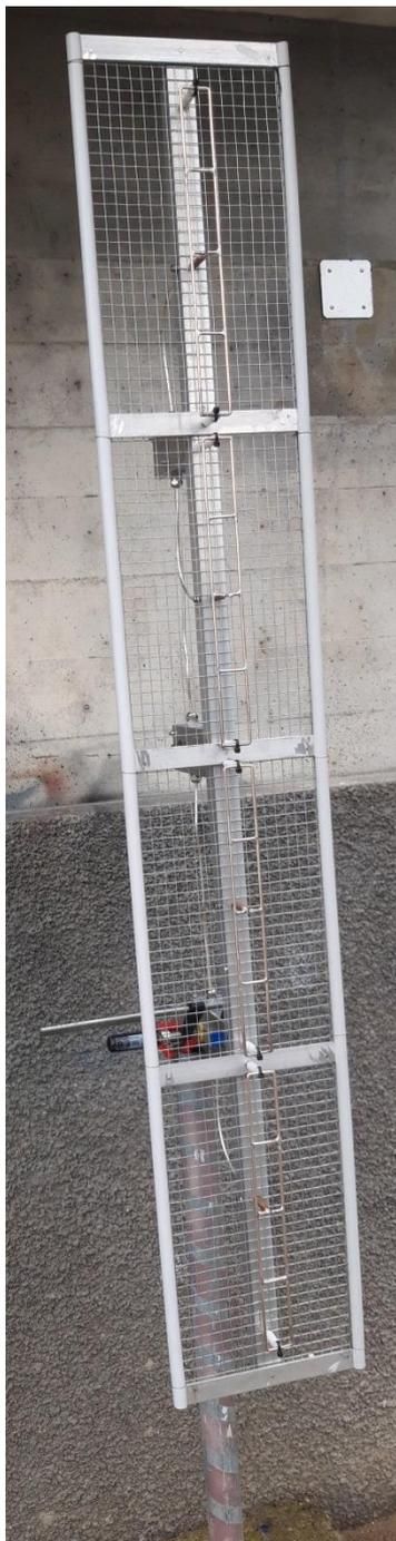
C'est là que ce type d'antenne devient intéressant. Nous obtenons, un angle d'ouverture à -3dB de 61,2° sur le plan horizontal et de 7,4° dans le plan vertical. Le gain simulé en espace libre vaut 18,46dBi.
