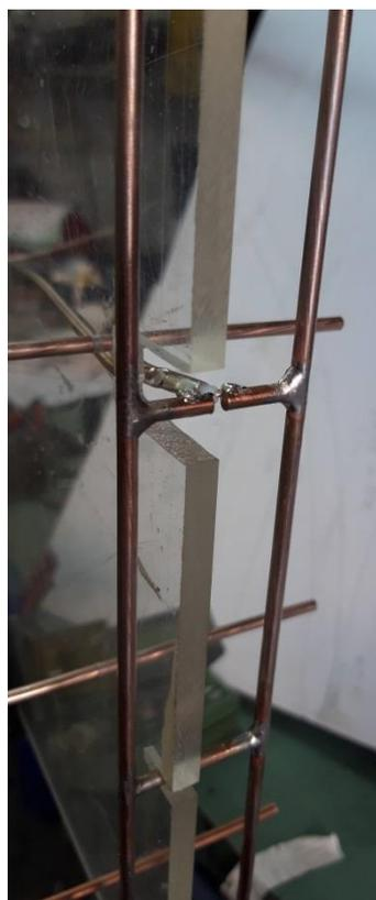
Le premier prototype a été monté sur une plaque de plexiglas. La mesure faite avec le TinyVNA (analyseur de réseau vectoriel) confirme les résultats obtenus avec EZ6+. Le réglage optimal du SWR se fait en ajustant l'espace entre l'élément rayonnant et les réflecteurs. Résultat concluant !
