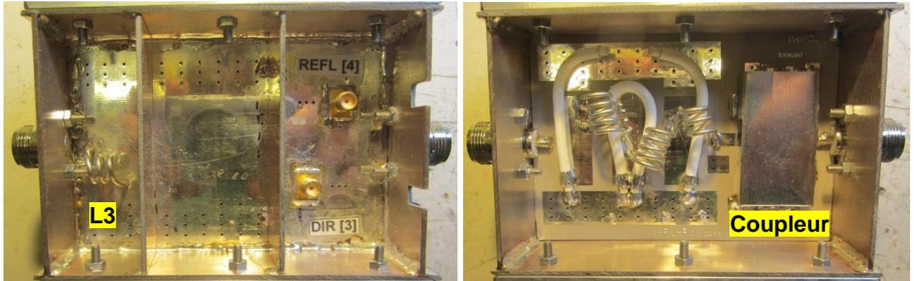
**Fig. 4 : Vue du filtre modifié ; dessous (gauche) et dessus (droite)**
