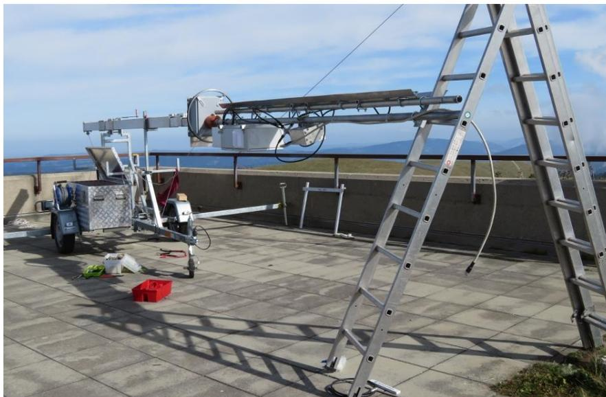
L'antenne « panneau » est un groupement de 4x « sextuple quad-long » avec réflecteur plan replié. Les simulations EZNEC faites par Florian donnent un gain de 20dB avec un angle d'ouverture horizontal de 48° et un angle vertical de 5°.
