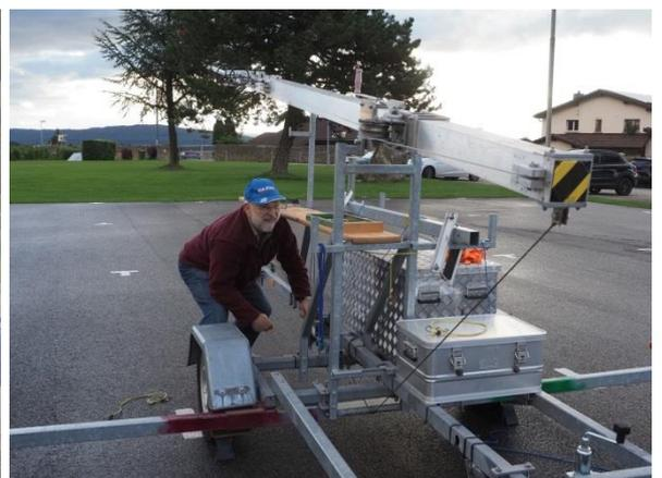
Le dipôle, pour la bande 80M que j'ai fabriqué pour l'occasion, est installé en V inversé à 120°, en un temps record. Grâce au mât sur remorque, une personne seule, met moins de 30 minutes pour l'installer. Hauteur 15m. Les extrémités sont à 4 mètres du sol.
