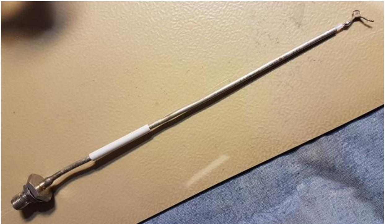
Ci-dessus, une sonde RF du pauvre : un condensateur de petite valeur (1-2pF) soudé directement au bout d'un tronçon de câble coaxial semi-rigide.
