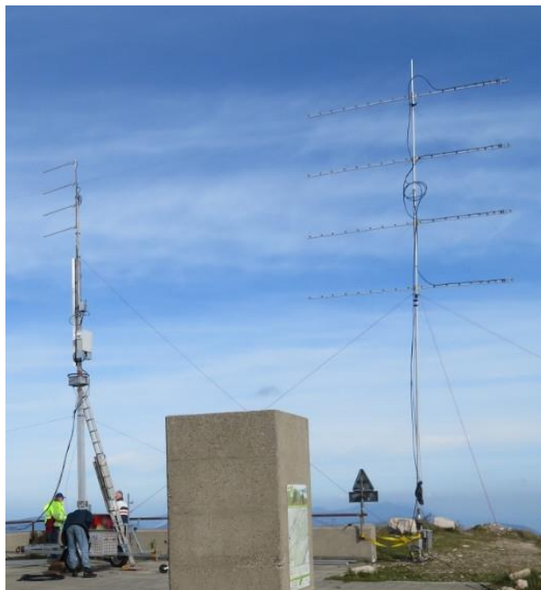
A gauche, les antennes pour le 23cm et à droite le groupement pour 70cm
