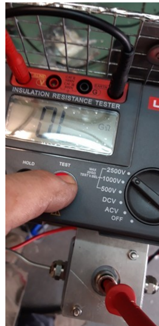
Un rapide test à 2000 VDC avant de souder les alimentations.
