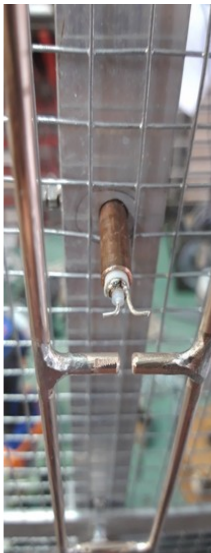
Un rapide test à 2000 VDC avant de souder les alimentations.
