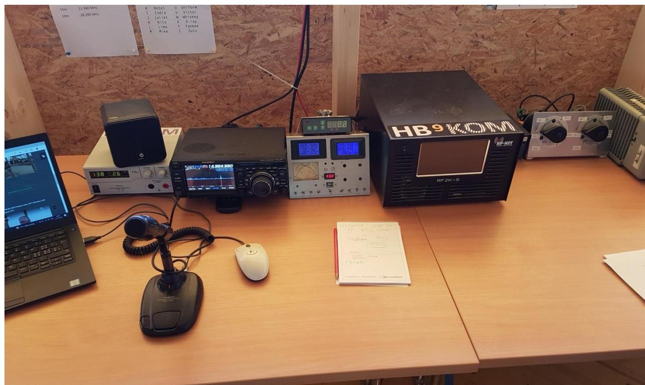
Un transceiver SDR de type MB1 de chez Expert Electronics était dédié exclusivement au FT-8 sur 10 MHz, et fonctionnait sans PA. A se demander si cet appareil est plutôt un transceiver dans lequel un PC a été intégré ou le contraire.
