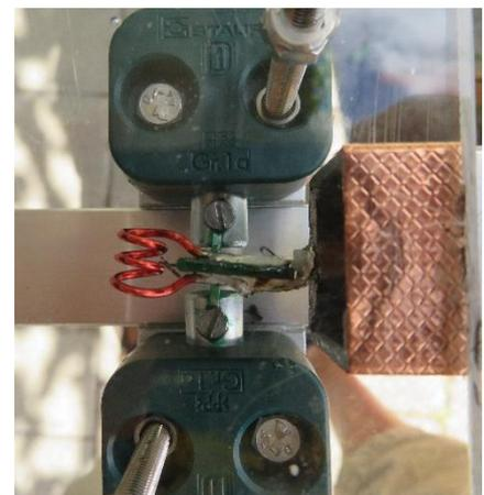
Un balun « bazooka » pour 144MHz a été réalisé sur le même principe. Le tube carré est plus long (470mm après ajustage), et il y a 3 pièces de centrage sur la longueur.
