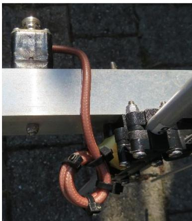
A gauche le balun pour 432MHz : 2 spires de coax téflon RF142 (5mm dia.) bobinés sur un diamètre de 17mm.
