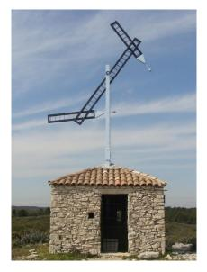
Le 1<sup>er</sup> réseau structuré de télécommunications date de 1791. Il est basé sur le système de télégraphe optique inventé par Claude Chape. Il permettait de transmettre de façon optique sur des distances supérieures à 14Km. Un message pouvait par exemple être transmis entre Paris et Bordeaux en 2 heures et demie.
